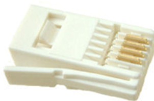
Рисунок 9-4. Штекер BT, используемый для аналоговых соединений ТфОП в Великобритании (обратите внимание, присутствуют только контакты 2–5)
